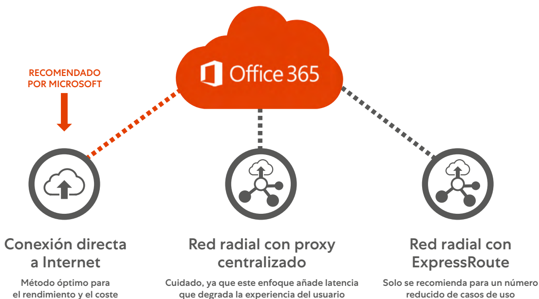
Figura 15: Microsoft recomienda una conexión directa a Internet como el método óptimo para mejorar rendimiento y coste, en consonancia con los principios de SSE (fuente: microsoft.com).
